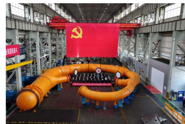
▲ 世界首台 500 兆瓦冲击式水电机组配水环管
